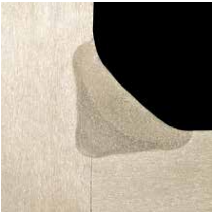
采用Alulinx气体的10毫米厚4140铝合金MIG角焊
