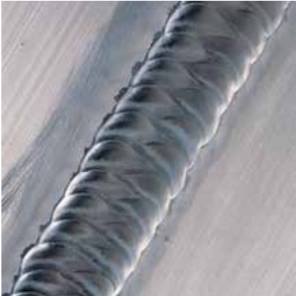
采用Alulinx气体的10毫米厚4140铝合金TIG对焊
