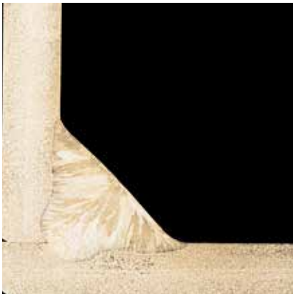
采用Inolinx MAG气体的3毫米奥氏体不锈钢板PB MAG (135)角焊
