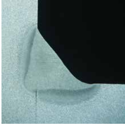
采用Ferrolinx F气体的8毫米厚碳素钢板 PB MAG (135) 角焊
